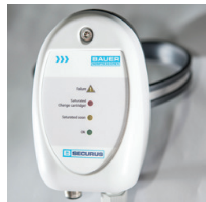
B-SECURUS: Messung der Patronensättigung und Anzeige der noch verbleibenden Filterpatronenstandzeit über ein Ampelsystem
